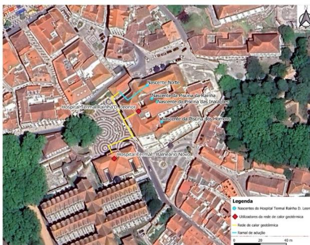
**Figura 1** – Planta Esquemática da Rede de Calor a construir com a localização das Nascentes do Hospital Termal.
