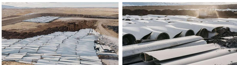
Figura 1 – Aterro de pás de turbinas eólicas feitas de compósitos termoendurecíveis não recicláveis (Energy Industry Review (2024)).
