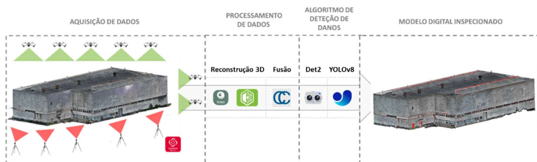
Figura 2 – Aplicação da metodologia a um ativo industrial
