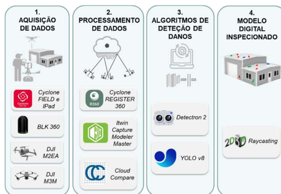
Figura 1 – Metodologia desenvolvida para obtenção de modelo digital inspecionado.
